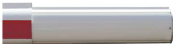
Profilé extrudé 102 x 82 mm • Extrêmement robuste - Testé avec barrière d'accès 4 M chargée à 600 kg en partie centrale • Equipé en partie supérieure avec une protection anti-assise de 13 mm et en partie inférieure avec une rainure pour vis avec une clé d'ajustage • Stabilisation supplémentaire par câble de tension à partir de 5,5 M • Laquage ÉPOXY de haute qualité en RAL 9010 HR (blanc semi mat) • Avec plusieurs bandes réflectos rouges de 0,5 m 3MTM
