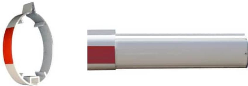
Profilé extrudé 102 x 82 mm • Extrêmement robuste - Testé avec barrière d'accès 4 M chargée à 600 kg en partie centrale • Equipé en partie supérieure avec une protection anti-assise de 13 mm et en partie inférieure avec une rainure pour vis avec une clé d'ajustage • Stabilisation supplémentaire par câble de tension à partir de 5,5 M • Laque ÉPOXY de haute qualité en RAL 9010 HR (blanc semi mat) • Avec plusieurs bandes réflectos rouges de 0,5 m 3MTM
